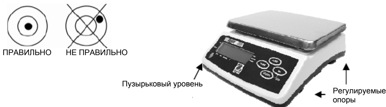
Рис. 2-1. Выравнивание весов в горизонтальной плоскости.
